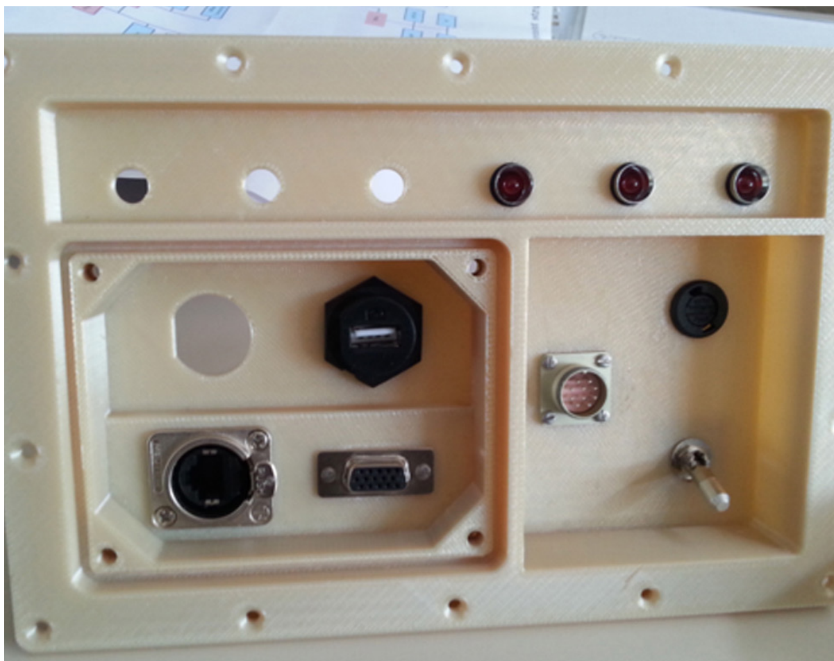
Componente di Mini-EUSO realizzato in resina ULTEM™ 9085 dal team dei Laboratori Nazionali di Frascati utilizzando la stampante 3D Fortus 450mc di Stratasys.
